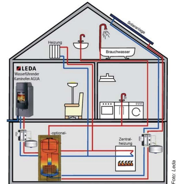
Mit der Wassertechnik ist es möglich geworden, Kachelöfen, Heizkamine und Kaminöfen nicht nur direkt über Konvektion und Strahlungswärme für die Beheizung von Einzelräumen einzusetzen, sondern auch weitere Räume zu beheizen.
